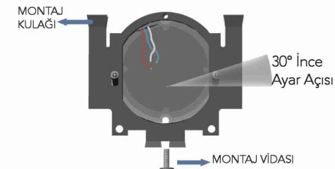
**i** Ürün montajı için kutu içeriğinden çıkan montaj sacını kullanınız. Montaj sacının anahtar kasasına montajı için uygun deliklerleri kullanınız. Sacın zemine dik monte edildiğinde emin olunuz. İnce ayarlama yapabilmek için montaj sacındaki delikler 30° sapmaya izin verir.
