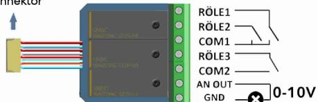
**i** Cihaz arkasına takılıp çıkarılabilen röle grubu ile Smart Touch Panel Mini üzerinden çeşitli aç kapat kontrolleri yapabilirsiniz ve 0-10VDC çıkış ile aydınlatmaları dimleyebilirsiniz. Röleler 277VAC 16A inrush 100A'e kadar dayanım gösterir yapışma yapmadan uzunu ömürlü kullanım sunar.
