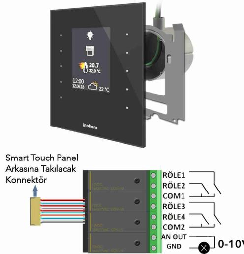
**i** Cihaz arkasına takılıp çıkarılabilen röle grubu ile Smart Touch Panel üzerinden çeşitli aç kapat kontrolleri yapabilirsiniz ve 0-10VDC çıkışı ile aydınlatma dimleyebilirsiniz. Röleler 277VAC 16A inrush 100A'e kadar dayanım gösterir yapışma yapmadan uzun ömürlü kullanım sunar.
