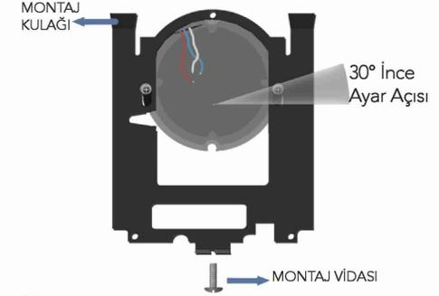
**i** Ürün montajı için kutu içeriğinden çıkan montaj sacını kullanınız. Montaj sacının anahtar kasasına montajı için uygun deliklerleri kullanınız. Sacın zemine dik monte edildiğinde emin olunuz. İnce ayarlama yapabilmek için montaj sacındaki delikler 30° sapmaya izin verir.
